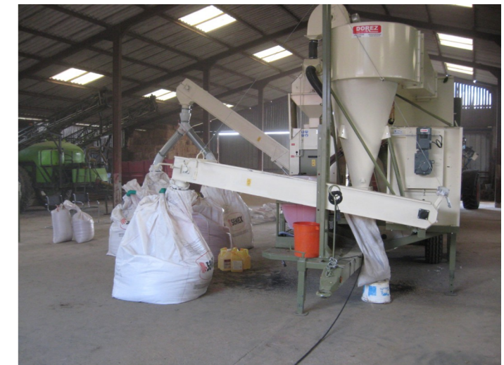
Convoyeur déchet à droite (BIG-BAG)
